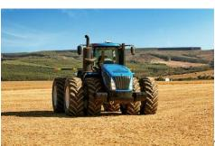
Tractor articulado New Holland T9.600, de la línea T9 PLM Itelligence, con motor de 542 CV y transmisión Full PowerShift.
