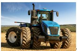
Tractor articulado New Holland T9.480, de la línea T9 PLM Itelligence, con motor de 426 CV y transmisión Full PowerShift.
