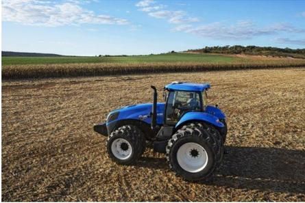
**Tractor New Holland T8.295, de la Línea T8 PLM Intelligence, con motor de 250 CV y transmisión Full PowerShift Ultra Command 18x4.**
