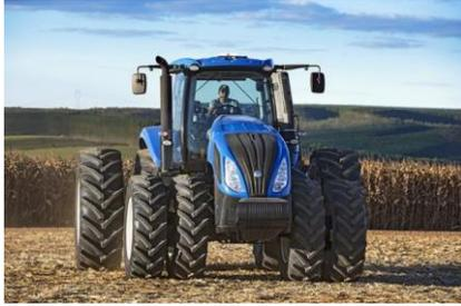
**Tractor New Holland T8.440, de la Línea T8 PLM Intelligence, con motor de 396 CV y transmisión Full PowerShift Ultra Command 21x5.**
