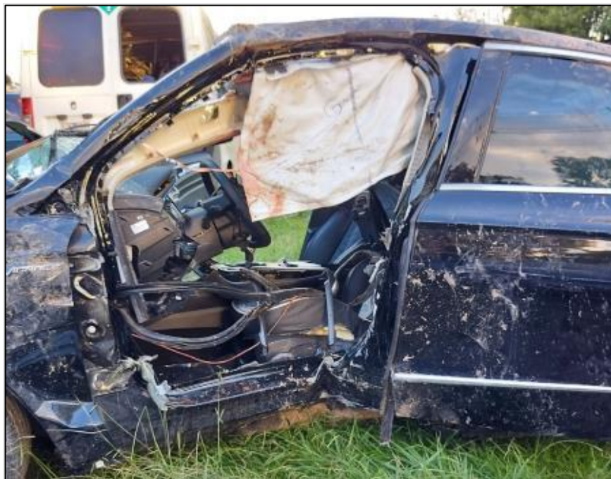
Figura 16. Fotografía de vista parcial del lateral izquierdo del vehículo, detalle sobre la zona de impacto. Fuente: JST
